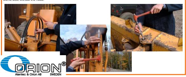
**Vitaliseraren** löser upp igensatta smörjställen, vilket gör det möjligt att få fram smörjfett, genom att trycka in en lätt flytande olja genom smörjnippeln. När verktyget är fäst vid smörjnippeln, behövs endast små lätta slag mot kolven för att rensa smörjstället.
